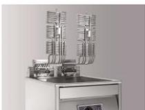
Relevage du corps de chauffe en position égouttage pour un nettoyage facile. Corps de chauffe spiralé qui offre une surface de contact encore plus importante avec l'huile.
